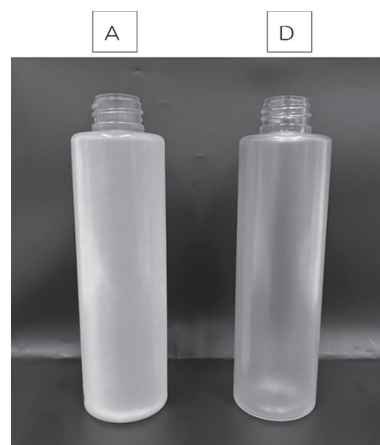
写真2 インジェクションブローボトルにおけるスリガラス性
